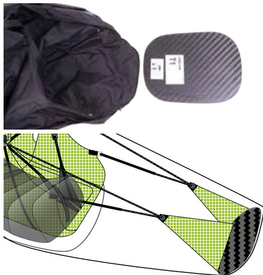
4. Una vez te hayas puesto la silla y te hayas cerrado las hebillas de las perneras y la ventral, el carenado se cierra empezando por la hebilla derecha (punto de vista del piloto), y luego se cierra la hebilla izquierda.
